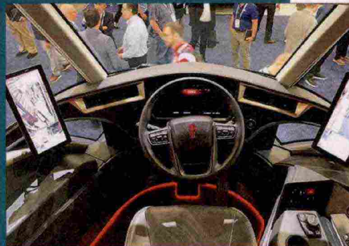
Il sedile del conducente è al centro della cabina e utilizza un sistema di telecamere e specchi digitali per la retrovisione.
